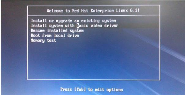
3. 在【Boot:】后输入 `vmlinuz initrd=initrd.img xdriver=vesa nomodeset dd`，然后按下 <Enter> 键。
