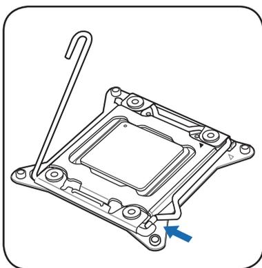
10. 推下左侧固定扳手(L)，然后将其插入固定扣下(M)。
