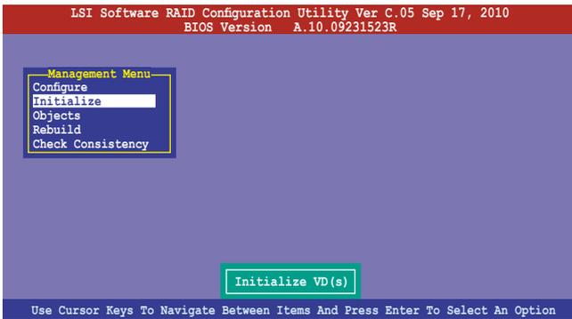
2. 画面中会显示可以进行初始动作的 RAID 设置，以及提示您选择虚拟磁盘来进行初始化。使用方向键来选择在 Virtual Drive 中的虚拟磁盘设备，然后按下空格键。
