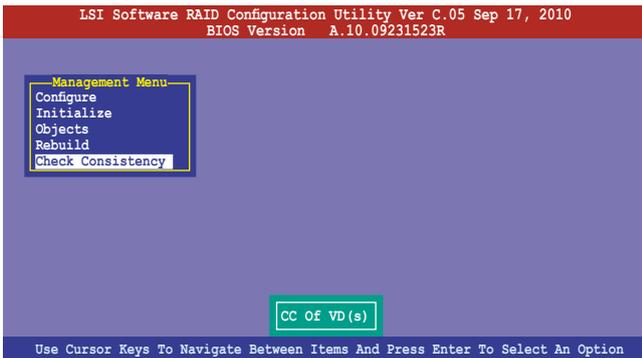
2. 画面中会显示可以进行初始动作的 RAID 设置，以及提示您选择虚拟磁盘来进行检查。使用空格键来选择在 Virtual Drive 中的逻辑磁盘设备，然后按下 <F10> 键。
