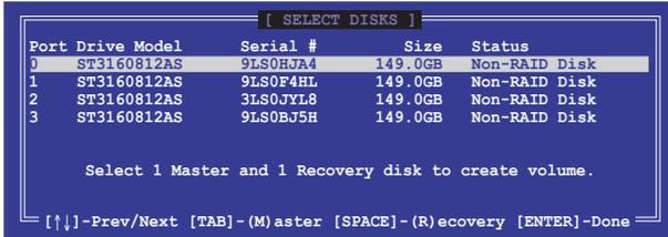
5. 请使用向上、向下方向键来选择硬盘设备，确认后请按下 <Tab> 键来选择 Master 硬盘设备，再按下空格键来选择 Recovery 硬盘设备。当所有选择完毕后，请按下 <Enter> 键。
