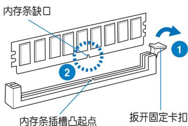
3. 最后缓缓将内存条插入插槽中，若无错误，插槽一端的白色卡扣会因内存条置入而自动扣到内存条两侧的凹孔中。
